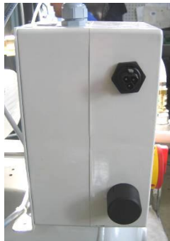
Klemmenkasten mit potentialfreiem Kontakt und akustischer Warneinrichtung
