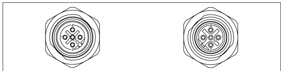
PIN-Belegung von Buchse und Stecker bei PROFIBUS oder CAN-Bus
