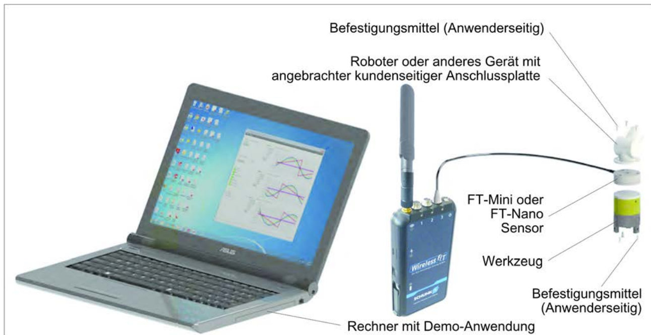
Installieren des Sensors
