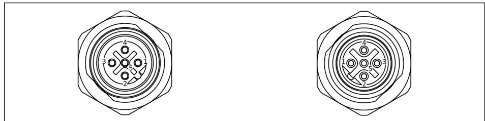
PIN-Belegung von Buchse und Stecker bei PROFIBUS oder CAN-Bus
