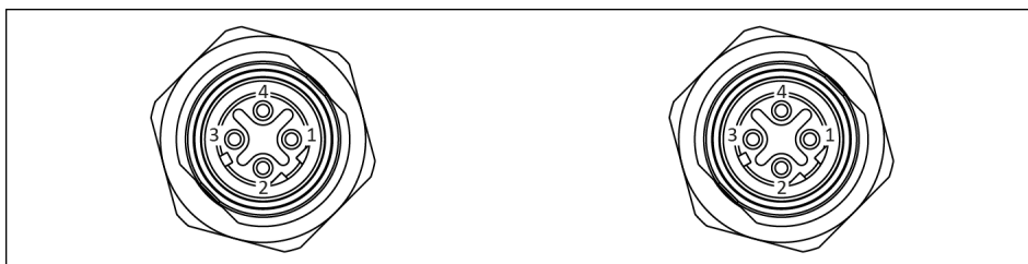
PIN-Belegung von Buchse und Buchse, Variante PROFINET
