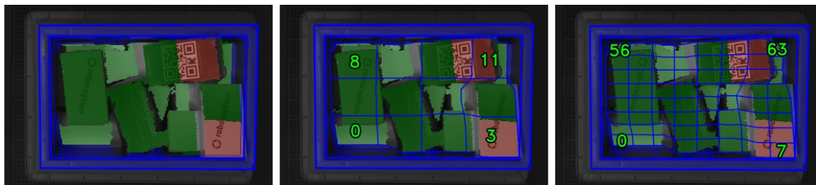
Abb. 7.11: Visualisierungen des Behälterfüllstands: Gesamtfüllstand ohne Raster (links), 4x3 Raster (Mitte), 8x8 Raster (rechts). Der Inhalt wird mit einem Farbverlauf von weiß (auf dem Boden) nach dunkelgrün dargestellt. Die überfüllten Bereiche sind rot dargestellt. Die Nummern stellen die Zell-IDs dar.
