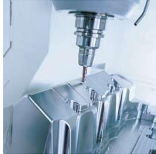
Form-Fräsen im Formenbau
