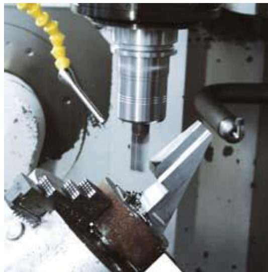
Fräsbearbeitung beim Schruppen von Gehäuseteilen mit TRIBOS-R
