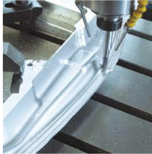
Formfräsen in der Schichtbearbeitung bei gehärtetem Stahl mit TRIBOS SVL
