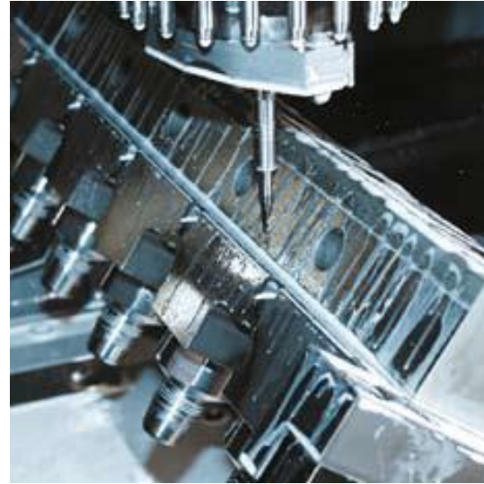
Bohren im Werkzeugbau mit TRIBOS-S
