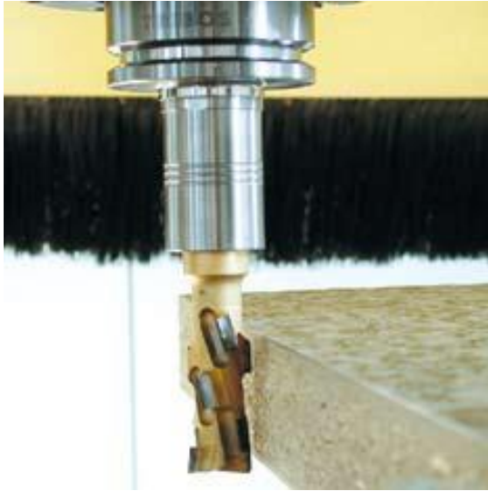
Mantelfräsen von Küchenarbeitsplatten mit TRIBOS-S (Holzbearbeitung)
