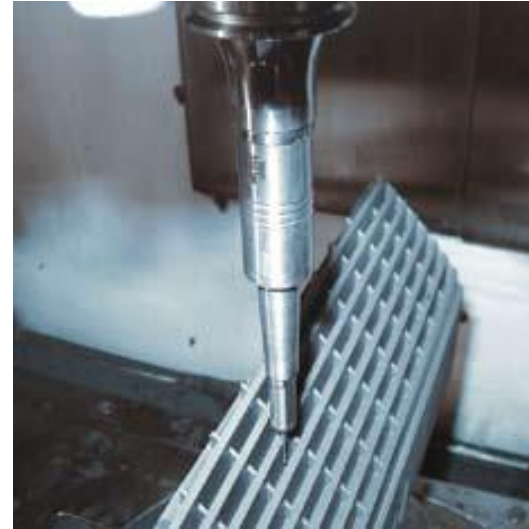
Elektrodenfräsen mit kleinen Durchmessern mit TRIBOS-Mini
