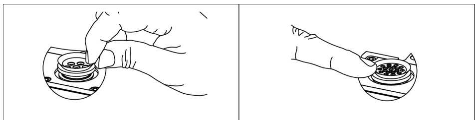
Dichtung des elektrischen Durchführungsmoduls entnehmen und einsetzen
