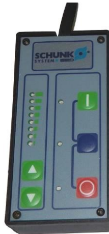
Abb. 11 Fernbedienung mit Anordnung der Taster/LED
