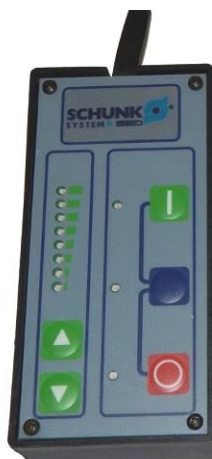
Fig. 11 Pulsantiera remota con pulsanti/LED
