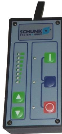
Abb. 7 Fernbedienung mit Anordnung der Taster/LED
