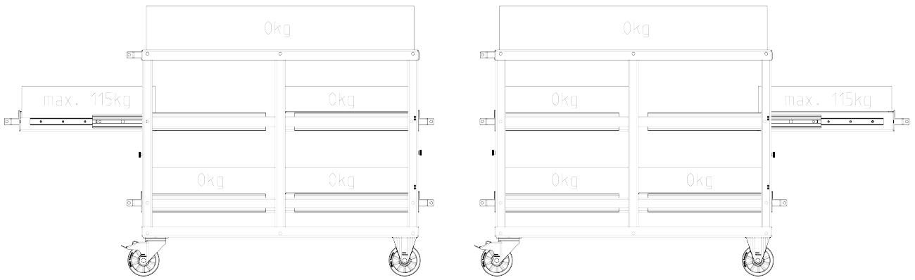
Maximale Beladung der oberen Schublade bei sonst unbeladenem Rüstwagen
